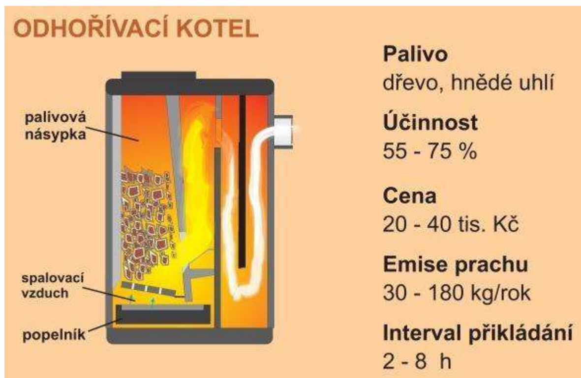
Obr. 2 Funkční schéma odhořivacího kotle
