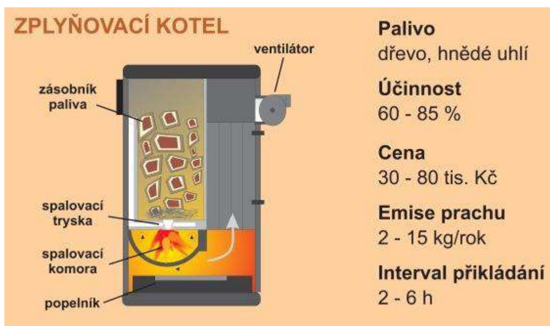
Obr. 3 Funkční schéma zplyňovacího kotle
