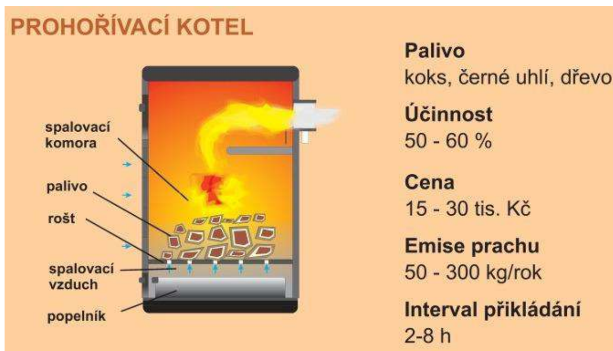
Obr.1 Funkční schéma prohořivacího kotle
