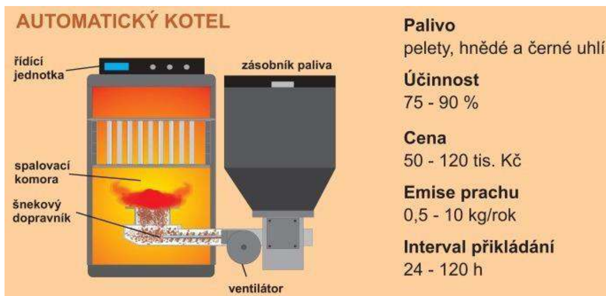
Obr. 4 Funkční schéma automatického kotle
